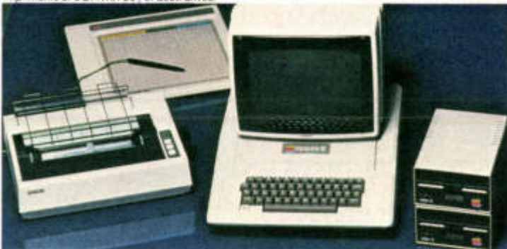
Le micro-ordinateur APPLE II avec un moniteur vert 12 pouces BMC ; une table à digitaliser ; une imprimante EPSON MX 80 ; et deux drives.
